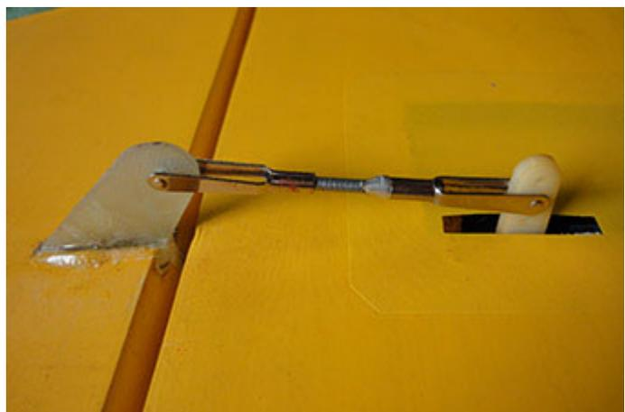
Bei Seitenruder und Bug- oder Spornrad sind Seilanlenkungen eine gute Lösung. Seile mit Kunststoffummantelung verwenden, die können, nachdem sie durch einen Hacken oder Augenschrauben gezogen wurden, einfach durch ein Stück Messingrohr gefädelt, dann zusammengequetscht und mit dem Feuerzeug verschmolzen werden. Ganz wichtig ist beim Seitenruder dabei auch immer ein Bügel, der das Verhängen des Schleppseils an den Ruderhörnern verhindert (Foto 3).
