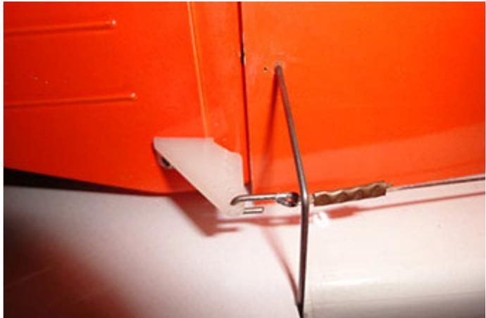
Für Ruderhörner gibt's mehrere Möglichkeiten: Entweder man verwendet Nylonruderhörner entsprechender Größe oder GFK-Ruderhörner. Jedenfalls muss immer eine ausreichend feste Holzeinlage im Ruder eingebaut sein, damit die Ruderkräfte auch sicher aufs Ruderhorn übertragen werden können. Bei Nylonruderhörnern ist die Verwendung von 2 solchen Ruderhörnern nebeneinander ideal, welche die Kugel eines ausreichend dimensionierten Kugelgelenks zwischen sich halten (Foto 4).
