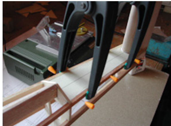
Bild 7 Einbau des Seitenleitwerkes
